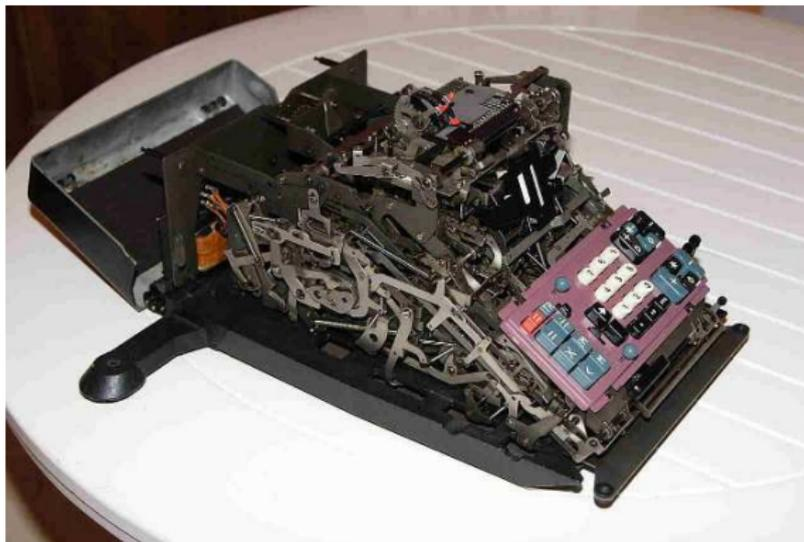
Une calculatrice électro-mécanique.
